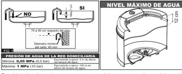
En el interior de su lavarropas encontrará la manguera de suministro de agua. Conecte la extremidad curvada de la manguera a la toma del lavarropas situada en su parte trasera. Conecte el otro extremo a un grifo de rosca 3/4" gas. Para evitar derrames es conveniente que la manguera permanezca conectada al grifo.
